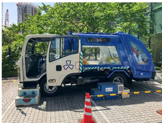
ごみ回収の様子が見えるスケルトンパッカー車
